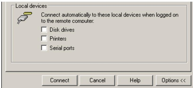
Windows XP mappt dann die Laufwerke des Steuerrechners wie Netzwerklaufwerke auf den R&S FSU.
