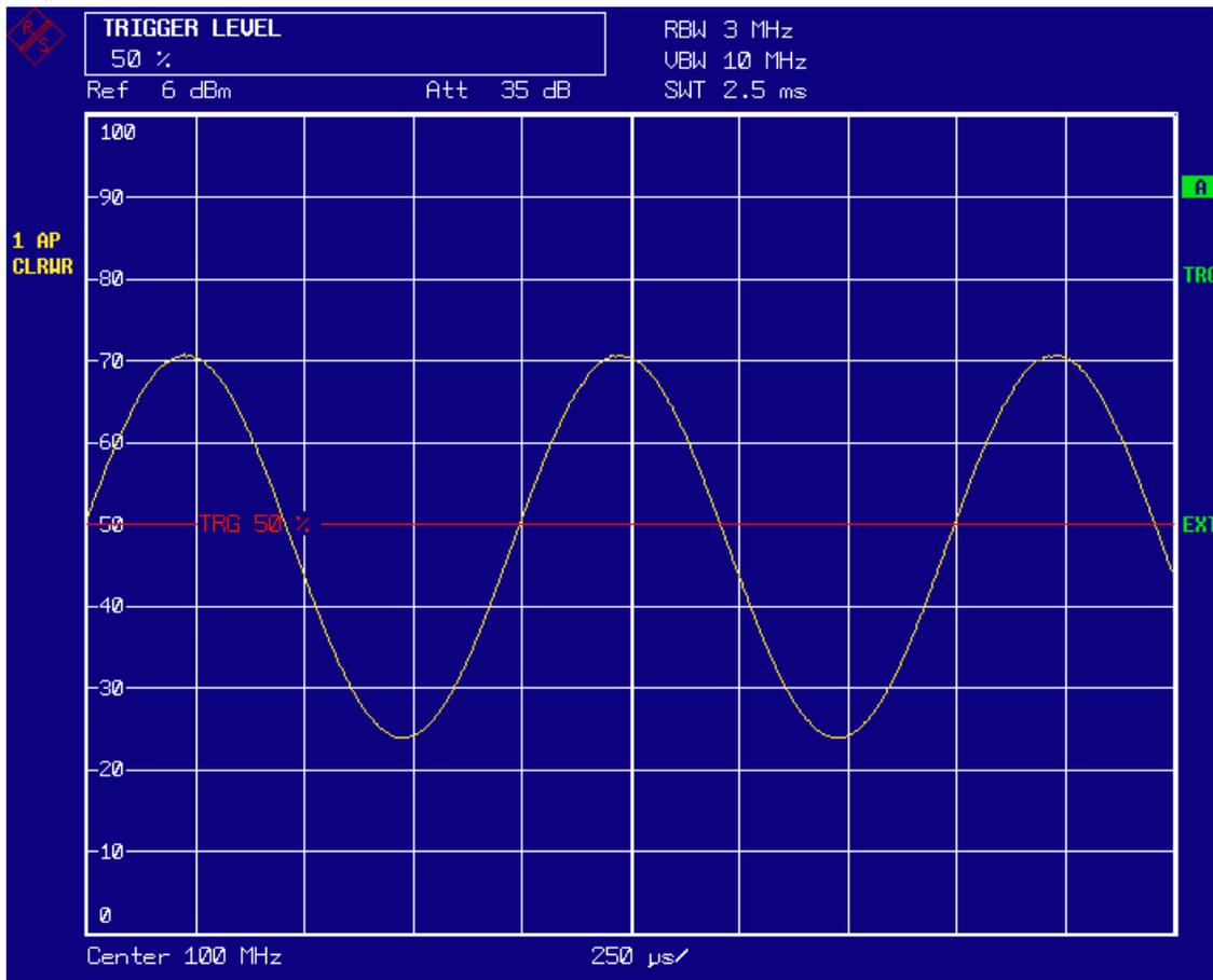
Fig. 5-16 Messung des NF-Signals eines mit 1 kHz AM-modulierten Trägers
