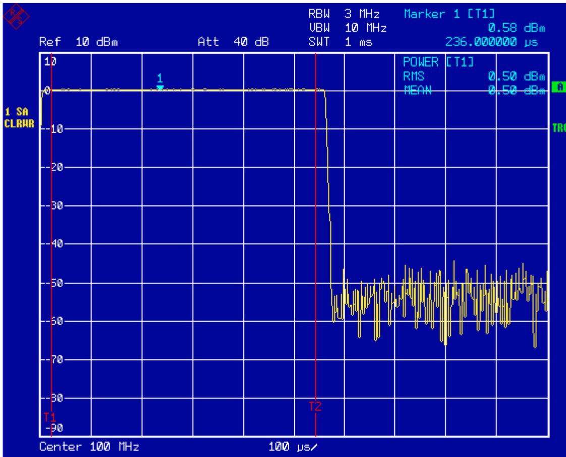
Fig. 5-11 Messung der mittleren Leistung eines GSM-Bursts.
