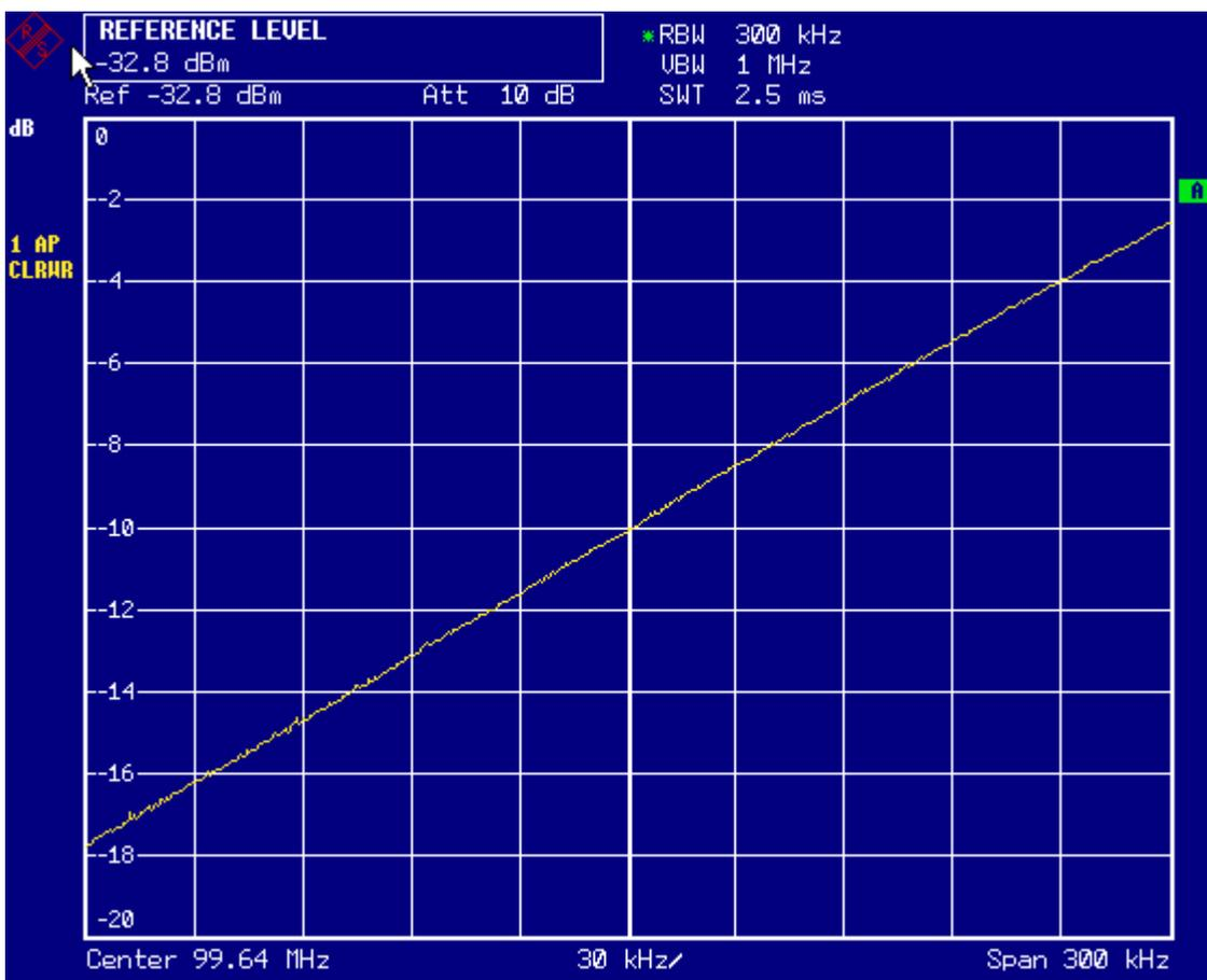
Fig. 5-17 Darstellung der Filterflanke des 300-kHz-Filters als FM-Diskriminatorekennlinie.
