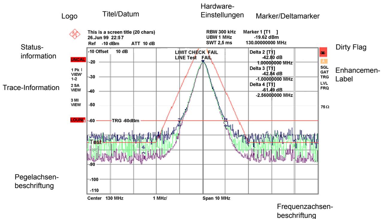
Fig. 4-1 Bildschirmaufteilung des R&S FSU im Analysatorbetrieb
