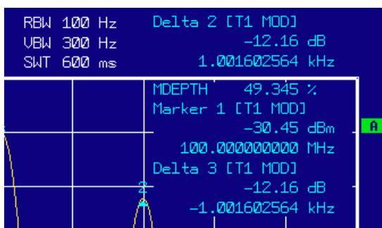
Fig. 5-10 Messung des AM-Modulationsgrades. Der Modulationsgrad kann hier in der Zeile *MDEPTH* = 49,345 % abgelesen werden. Die Frequenz des NF-Signals kann der Frequenzanzeige der Delta-Marker entnommen werden.
