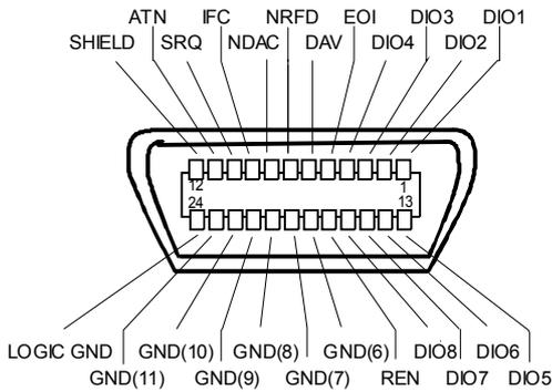
Fig. 1-9 Belegung der zweiten GPIB-Schnittstelle
