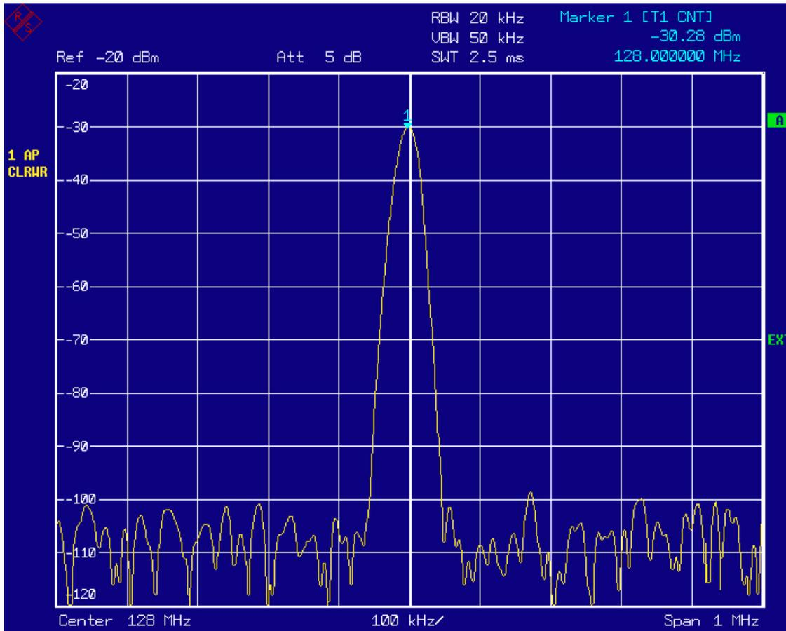
Fig. 5-1 Messung der Frequenz mit dem Frequenzzähler
