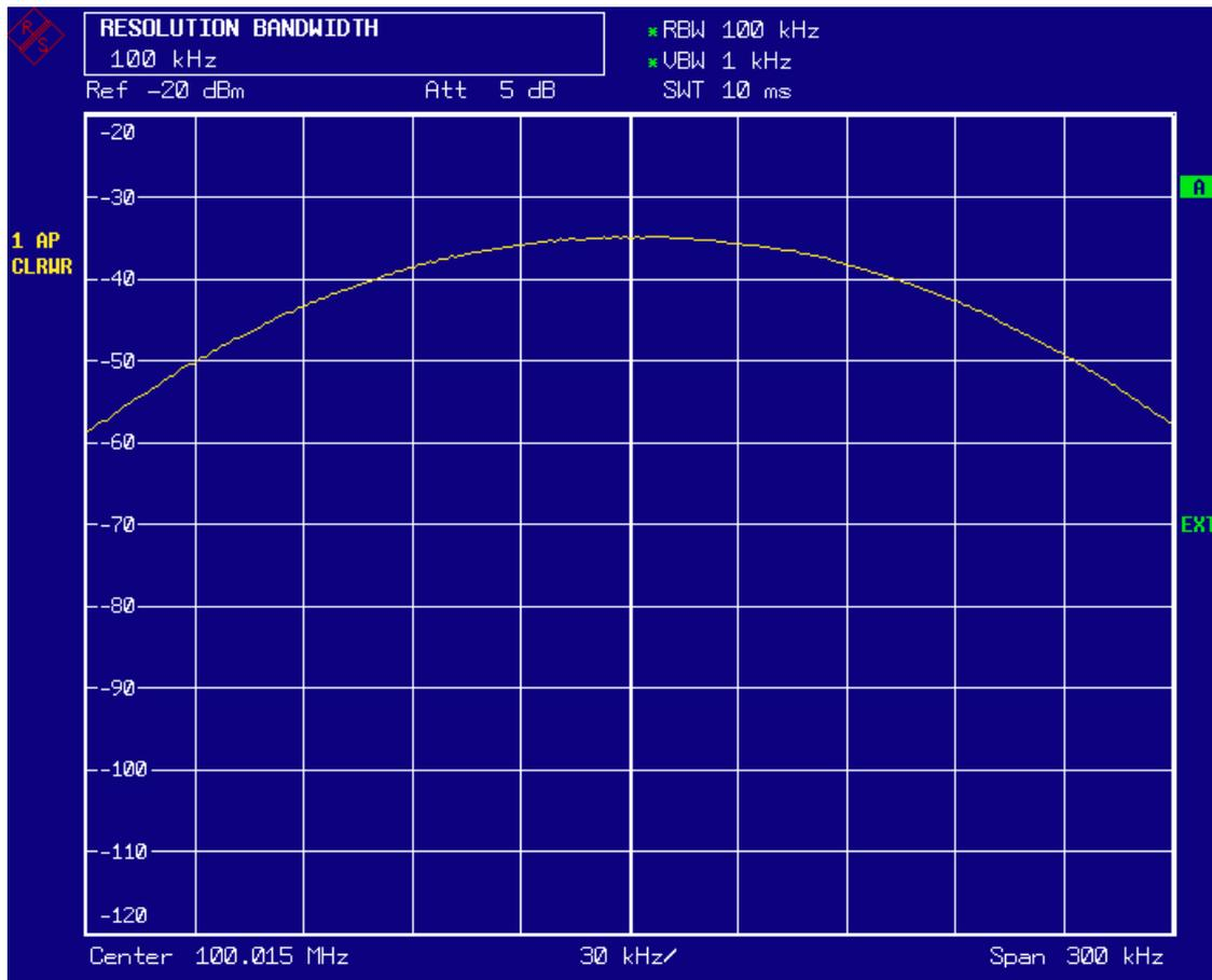
Fig. 5-7 Messung von zwei gleich großen HF-Sinussignalen mit einer Auflösebandbreite, die größer als deren Frequenzabstand ist.
