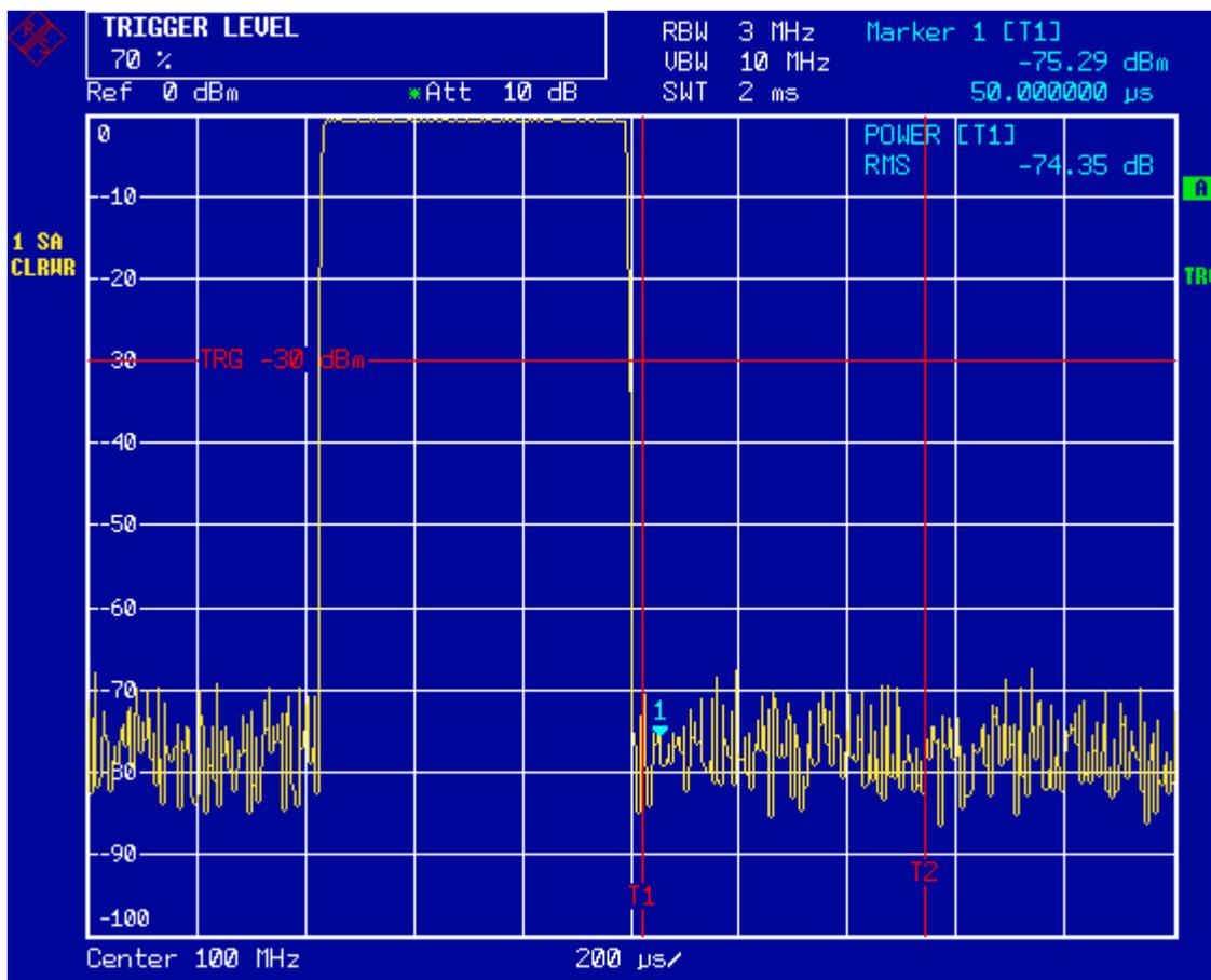
Fig. 5-15 Messung des Signal-/Rauschverhältnisses eines GSM-Burst-Signals im Zeitbereich
